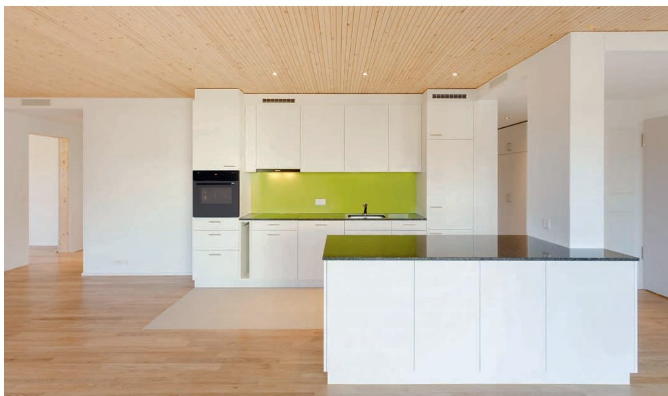
Die Wohnungstrennwände und Decken erfüllen als tragende und raumabschliessende Bauteile die Brandschutzanforderungen REI60.
